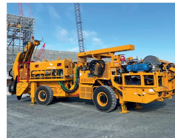
Une boulonneuse à batterie.
