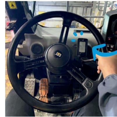
À la mine, les opérations sont en continu 24 heures sur 24 et les opérateurs travaillent en alternance sur des horaires de 12 heures, de jour et de nuit. Nous avons ainsi installé, dans tous nos camions de production 793F, une technologie développée ici, au Québec. Un appareil de la grosseur d'un cellulaire situé près du volant émet une lumière bleue qui permet d'améliorer la présence d'esprit du conducteur et sa vitesse de réaction.
