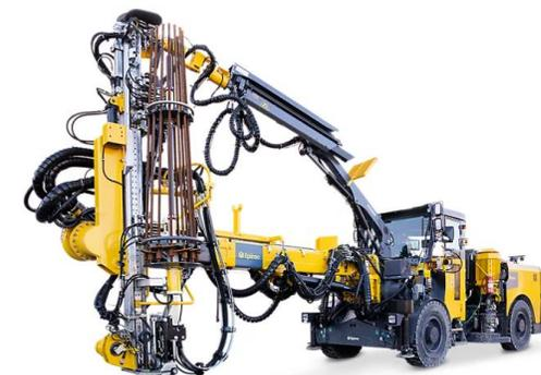
*Boulonneuse Boltec M10 (1 à venir)*
