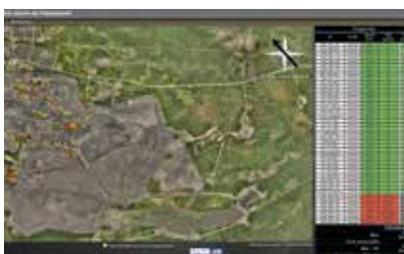
**CARTE ACOUSTIQUE DYNAMIQUE** pour identifier en temps réel les bruits prédominants des équipements, en fonction de la direction et de la vitesse du vent.
