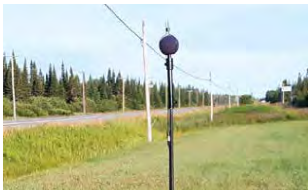
2 STATIONS ACOUSTIQUES MOBILES pour mesurer en temps réel le bruit à proximité des travaux du Projet Extension Malartic.
