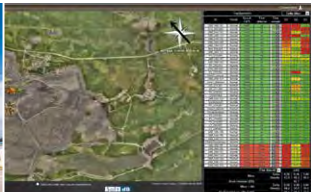
CARTE ACOUSTIQUE DYNAMIQUE pour identifier en temps réel les bruits prédominants des équipements, en fonction de la direction et de la vitesse du vent.
