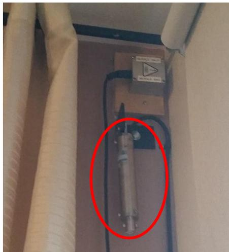
Figure 6 : Détail d'un Tilt-mètre
