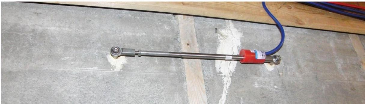
Figure 1 : Extensomètre
